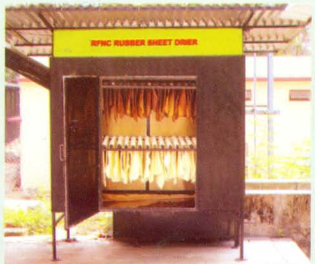
पोर्टेबल प्रकार के आरएफएनसी रबर शीट ड्रायर, जो एमएस एंगल, फ्लैट तथा बांस की प्लाईवुड से निर्मित हैं, का एक दृश्य
