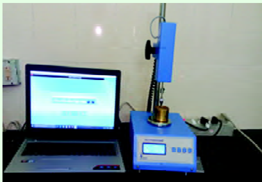
आकृति 3: 8 प्रतिशत सीमेंट मिलाने के पश्चात लिक्विड लिमिट के निर्धारण के लिए डिजीटल कोन पेनेट्रोमीटर
