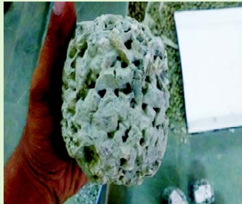
कैप्शन: 1. आकृति-1. अपघर्षण रोधकता (ए) परीक्षण के बाद नमूना (बी) प्रथम श्रृंखला के प्रयोगों में सम्पीड़क सामर्थ्य के साथ घन हानि विचलन
