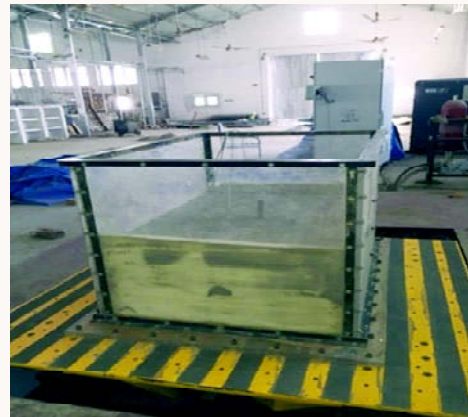
आकृति-2 (ए) : रेत नमूने के साथ मॉडल परीक्षण टैंक
