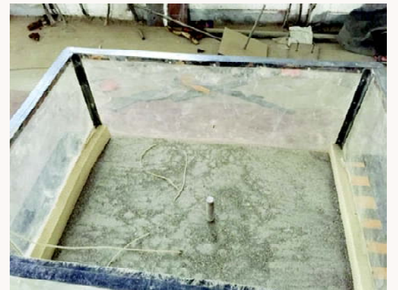
आकृति-2 (बी) : बाउन्ड्री प्रभावों को शून्य करने के लिए फोम का उपयोग
