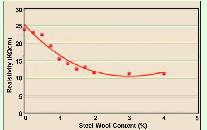
चित्र 2: कंक्रीट की प्रतिरोधकता पर स्टील वूल का प्रभाव
